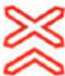
1.4 «Многопутная железная дорога». Обозначение необорудованного шлагбаумом переезда через железнодорожную дорогу:
